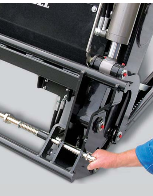
Процесс фиксации навесного оборудования безопасно осуществляется сбоку.
