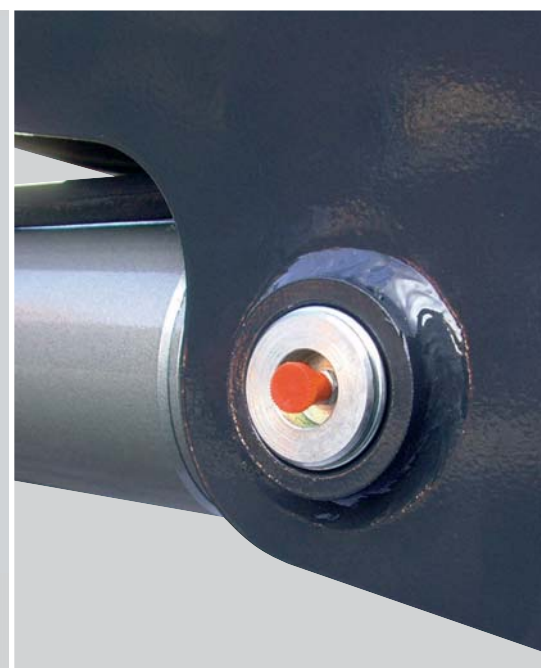
Каждая втулка смазывается в отдельности.
